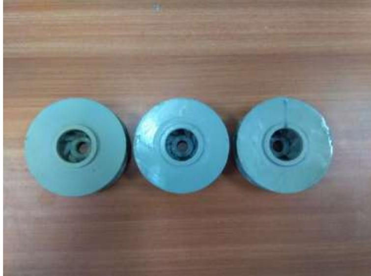
**Gambar 9.** Objek penelitian *impeller* tertutup
